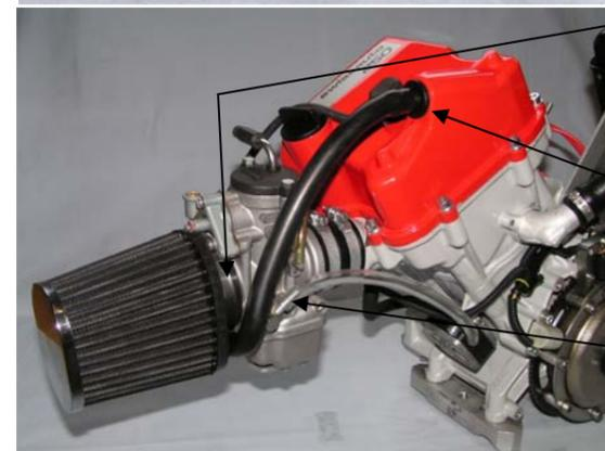
Montieren Sie den Luftfilter am Vergaser und ziehen die Schlauchklemme fest.
