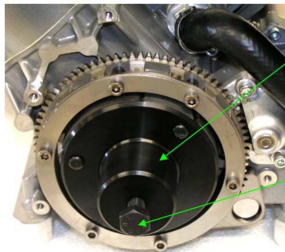
Schrauben Sie den Kupplungsabzieher so weit wie möglich von Hand in den Kupplungsträger.
