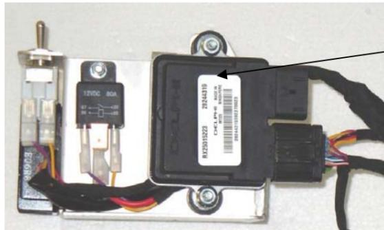
Montieren Sie das Steuergerät auf die beiden Silentblöcke und ziehen Sie die beiden Flanschmuttern M6 fest. Verlegen Sie alle Kabel unter dem Steuergerät.
