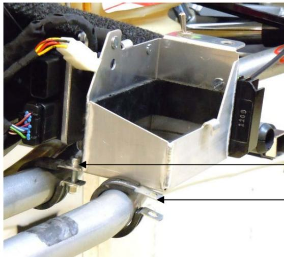
Befestigen Sie den Batteriekasten mit der ersten Rohrschelle am Rahmen.
