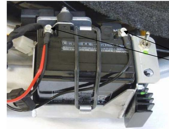
Befestigen Sie das Plus- und Minuskabel mit den mitgelieferten Nutensteinen und Schrauben.
