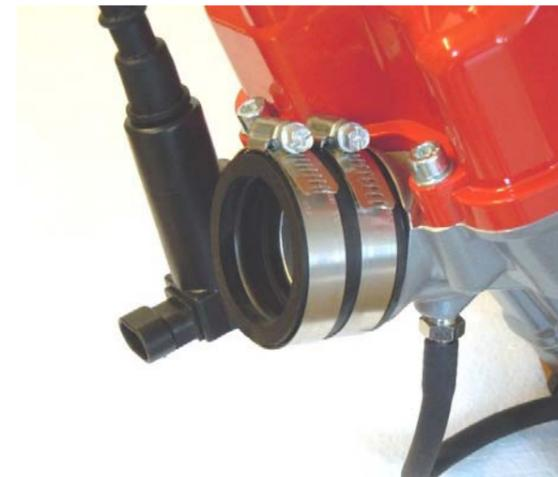
Legen Sie beide Schlauchklemmen auf den Vergasergummi und stecken diese auf den Ansaugflansch.
