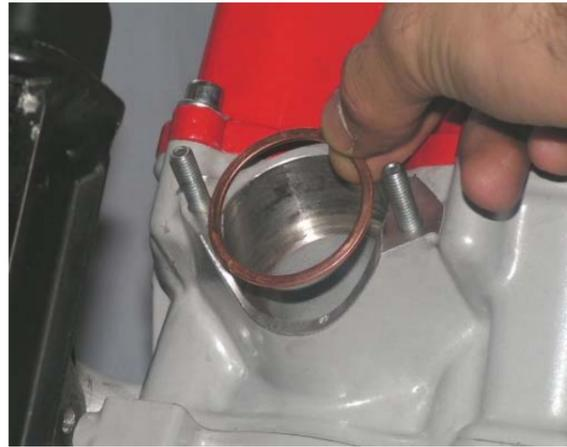
Legen Sie die Auspuffdichtung in den Auslasskanal. Montieren Sie den Auspuffkrümmer lose mit 2 Flanschmutter M6.
