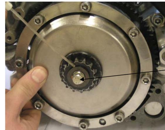
Drücken Sie die Kupplungsglocke nach hinten und spritzen das Kettenspray zwischen Ritzel und Anlaufscheibe.
