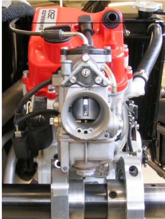
Montieren Sie das Gaskabel am Vergaser und verlegen es mit der Gaskabelhülle am Sitz entlang.
