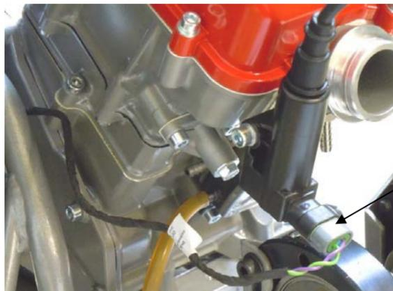
Verbinden Sie die Zündspule mit dem Kabelstrang.
