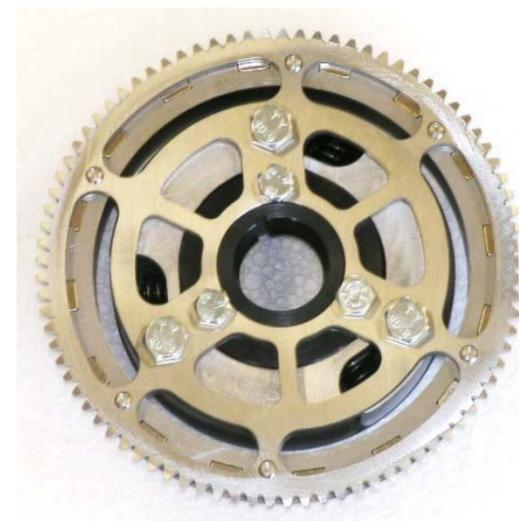
Montieren Sie die Kupplung wieder auf den Starterkranz.
