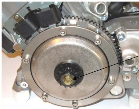
Montieren Sie die Kupplungsglocke und das Ritzellager.
