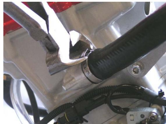
Verpressen Sie alle 4 Schlauchklemmen mit einer Beisszange.
