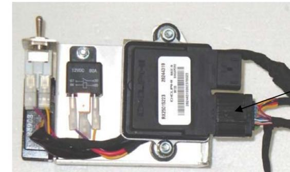
Verbinden Sie den Motorenkabelstrang mit dem Steuergerät am Batteriekasten.
