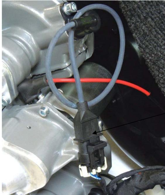
Verbinden Sie den Kurbelwellensensor mit dem Kabelstrang.
