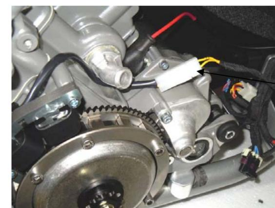
Stecken Sie das Starterkabel (rot) an den freien Steckplatz am Starterrelais.
