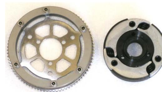
Jetzt können Sie die Kupplung vom Starterkranz trennen. Nun können Sie die komplette Kupplung oder nur die Kupplungsbacken wechseln.
