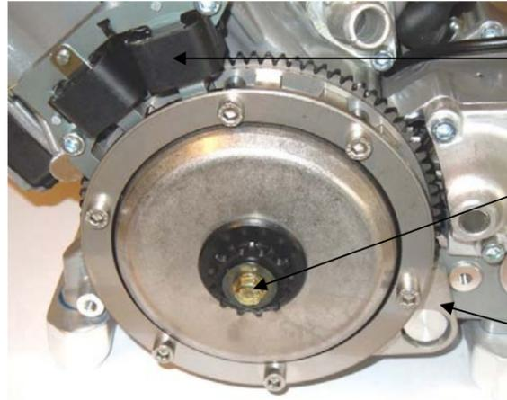
Entfernen Sie den Generator-Stator.
