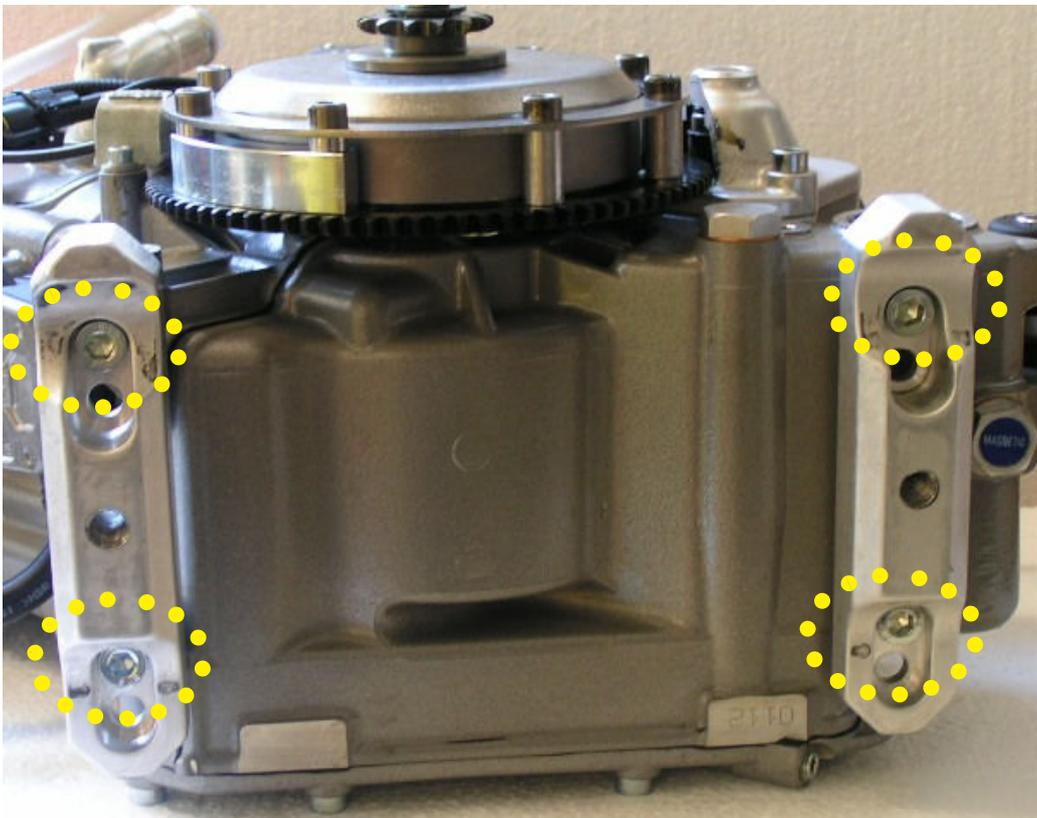
Da sich bei der vorderen Motorhalterung die Schraubenlöcher nahe an der Ölwanne befinden, dient der Loctite hier zur Abdichtung. Damit im Falle eines Durchbruchs der Gewindebohrung in den Ölraum kein Ölverlust entsteht.
